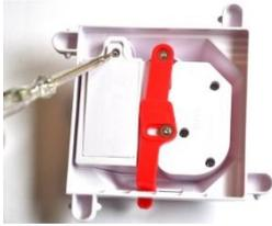
Mit einem Schraubendreher, das Batteriefach öffnen
