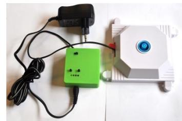
Alternativ ist das Modul über ein 9 Volt Netzteil über die installierte Buchse in Betrieb zu nehmen. Dabei muss stets der 9 Volt Block entfernt werden.
