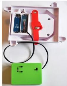
Batterieatrappen (1) rechts und (2) links mit der richtigen Polung in das Batteriefach einsetzen (siehe Aufdruck).
