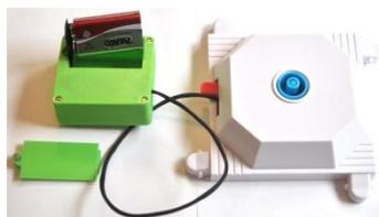
Im weiteren Schritt einen 9 Volt Block anschließen und ins Batteriefach einlegen.
