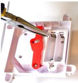
Mit einer Spitzzange in der Ecke des Batteriefachs eine kleine Einkerbung vornehmen, sodass das Kabel nach außen verlegt werden kann.
